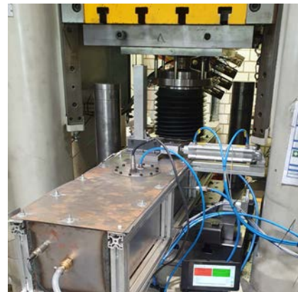
Enceinte pour outils pour le forgeage en atmosphère appauvrie en oxygène lors de tests à l'IFUM (Hannovre).
