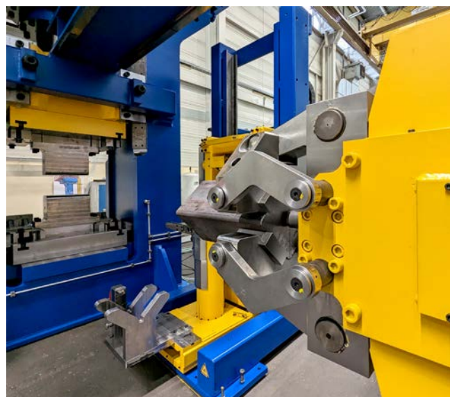
La presse et les manipulateurs sont contrôlés par une F-CPU.
