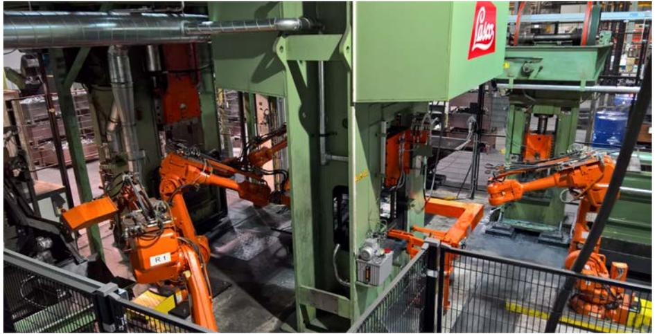
Im finnischen Billnäs werden vollautomatisch - Fertigungslinie (Bild oben) - hochwertige Axtklingen der Marke Fiskars™ - wie links abgebildet - hergestellt. LASCO integrierte vorhandene und neue Anlagenkomponenten zu einer leistungsfähigen, vollautomatisierten Fertigungsanlage.
