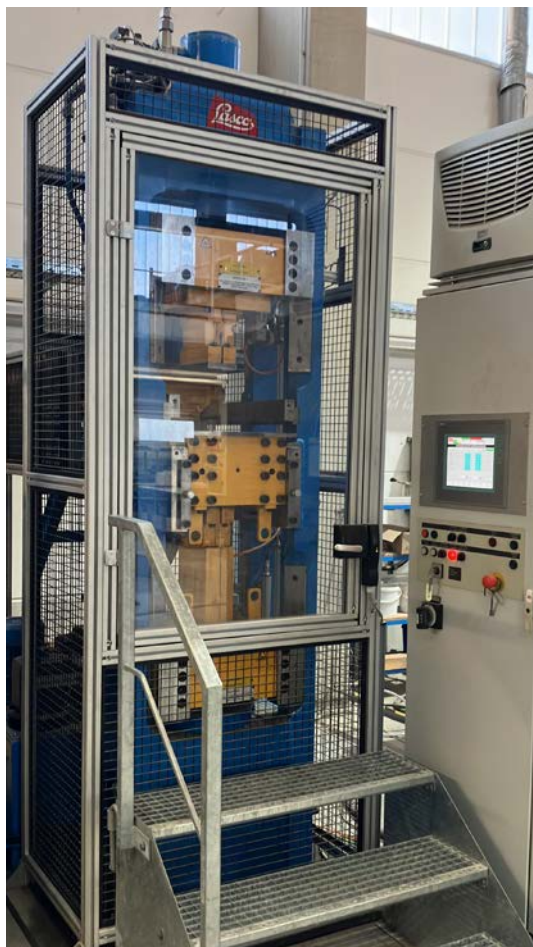
Специально адаптированный LASCO лабораторный пресс института IAB прикладных строительных исследований ИАБ Веймар гГмбХ.
