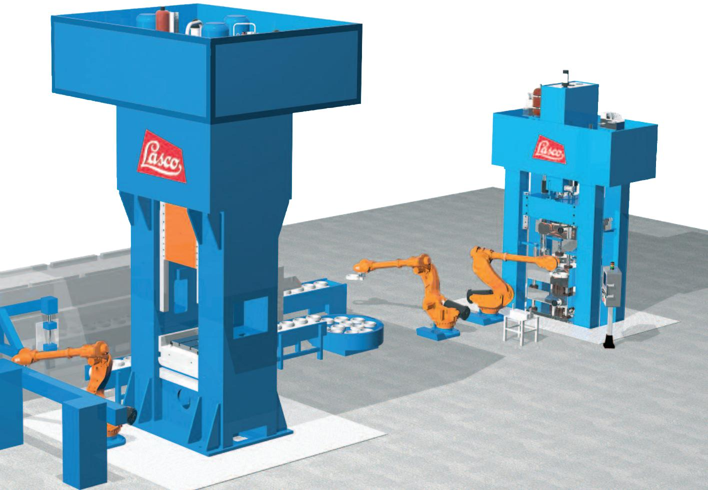
Схематическое изображение производственного участка из двух синхронно работающих прессов VPE 500 и MPP 400 с устройствами автоматизации.
