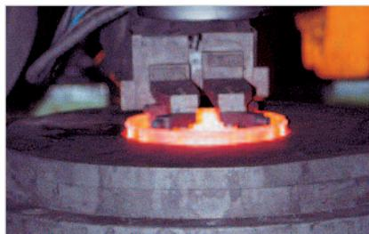
Горячая калибровка колец синхронизаторов, изготовленных методом прессования металлического порошка.
