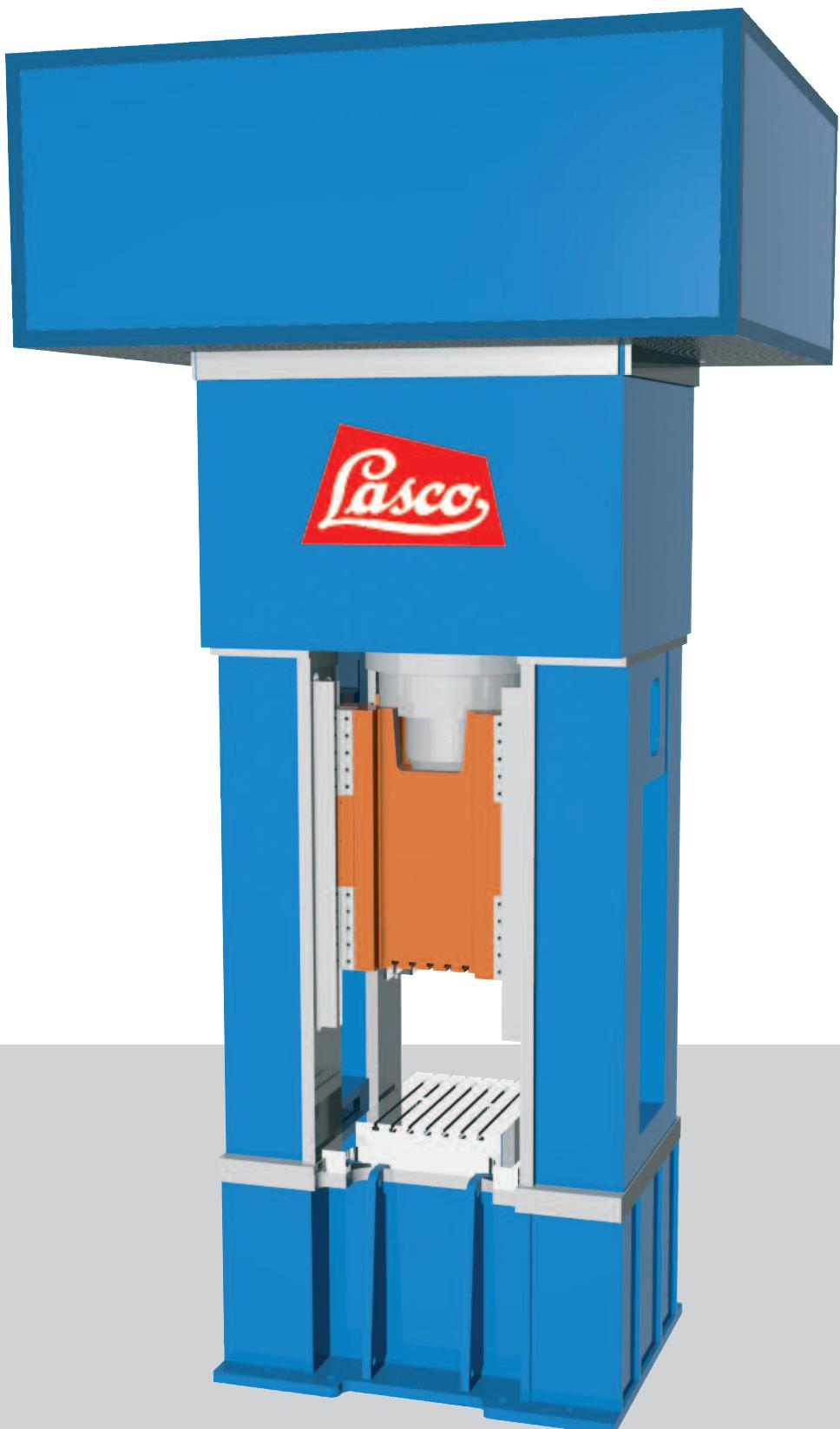
Схематическое изображение базовой конструкции пресса серии KFP производства LASCO.
