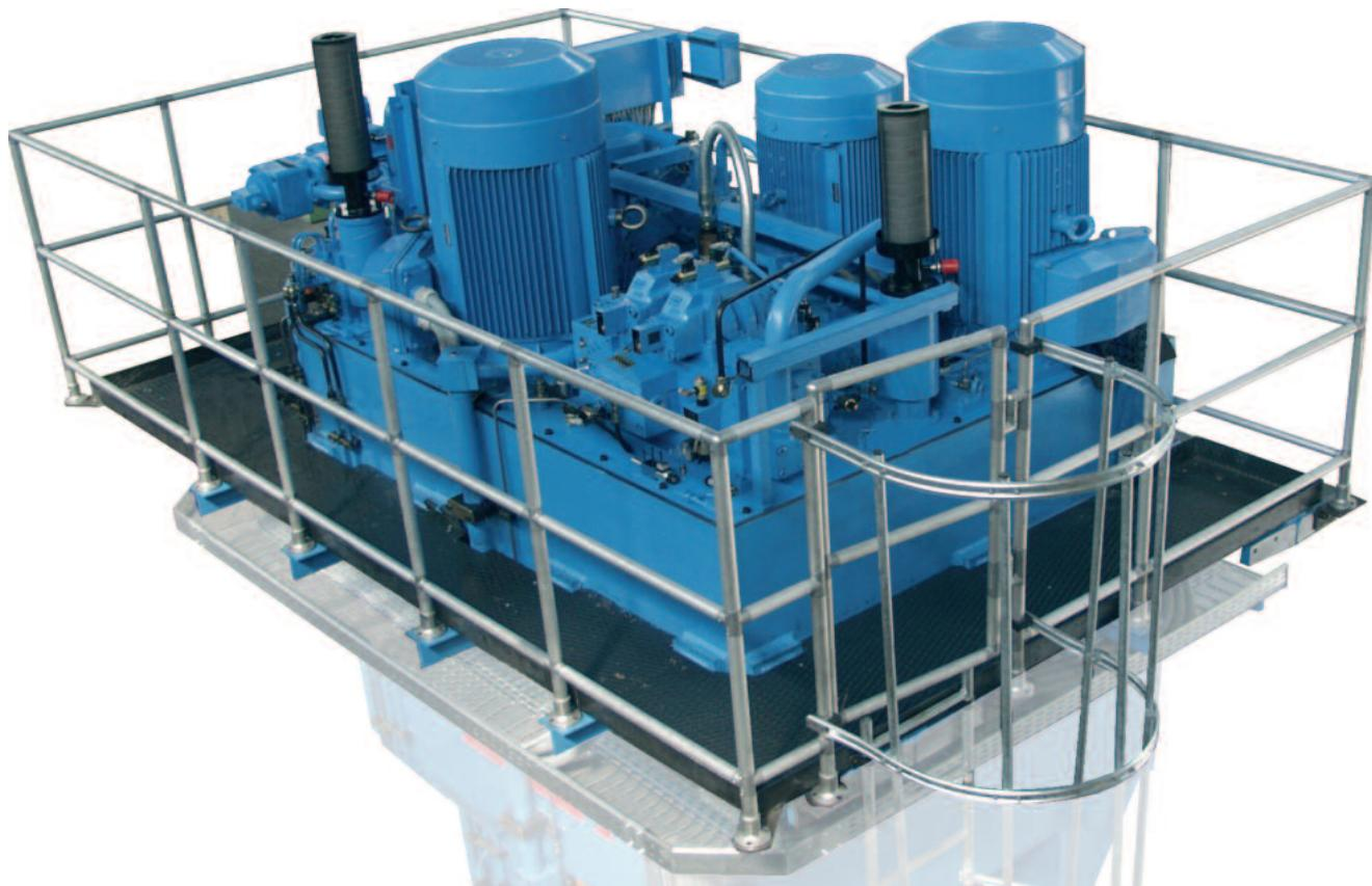
Гидравлический привод на площадке в верхней части пресса.
