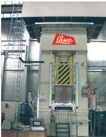
Пресс KFP 1000, штамpuющий алюминиевые детали для автомобильного производства.
