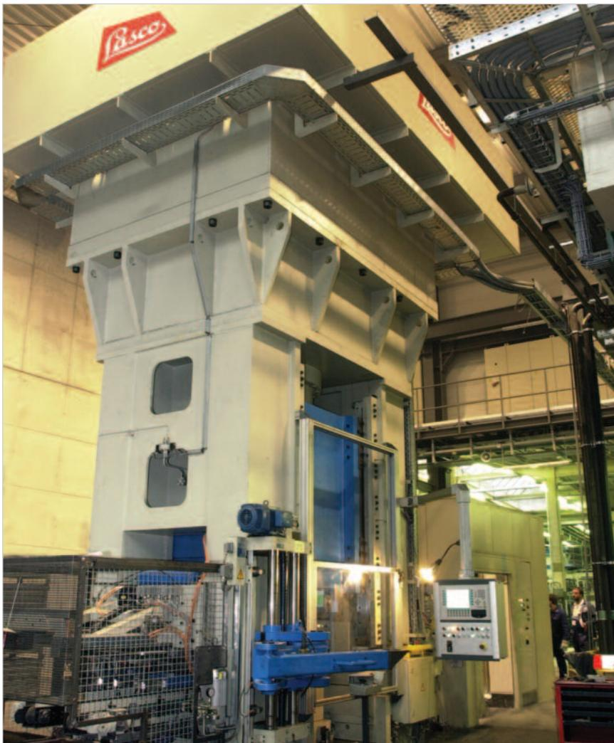
Пресс для холодной штамповки KFP 1000 производства LASCO на участке изготовления автомобильных деталей. Один из более тысячи гидравлических прессов компании LASCO, работающих на промышленных предприятиях во всем мире.
